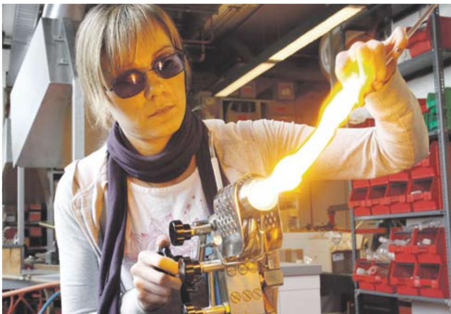
**Oben: Die blaue Brille dient Glasapparatebauerin Corinna Banditt als Schutz vor grellem Licht und hohen Temperaturen. Beides erzeugt die Propangasflamme, mit deren Hilfe Banditt Glasstücke biegsam macht**
